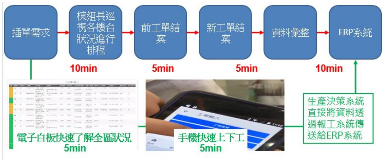
圖 2 扣件智慧工廠採用快速生產決策系統
