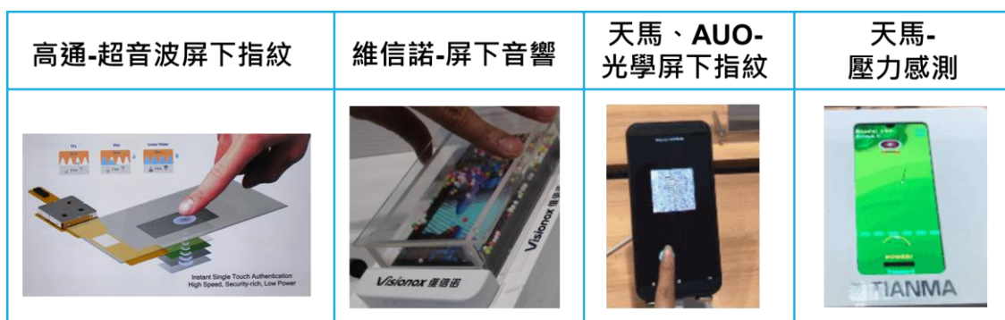
圖 1 全螢幕手機與感測元件的整合
