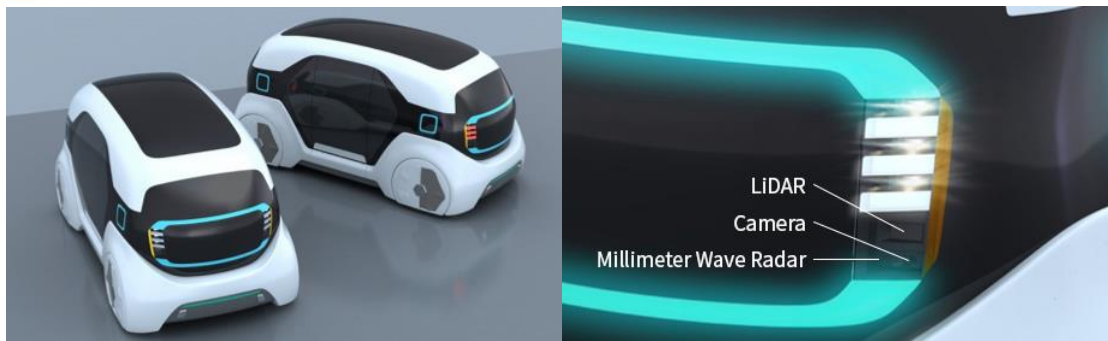
圖 9 Koito 展示自動駕駛車的車用光達、雷達與感測的車燈模組
