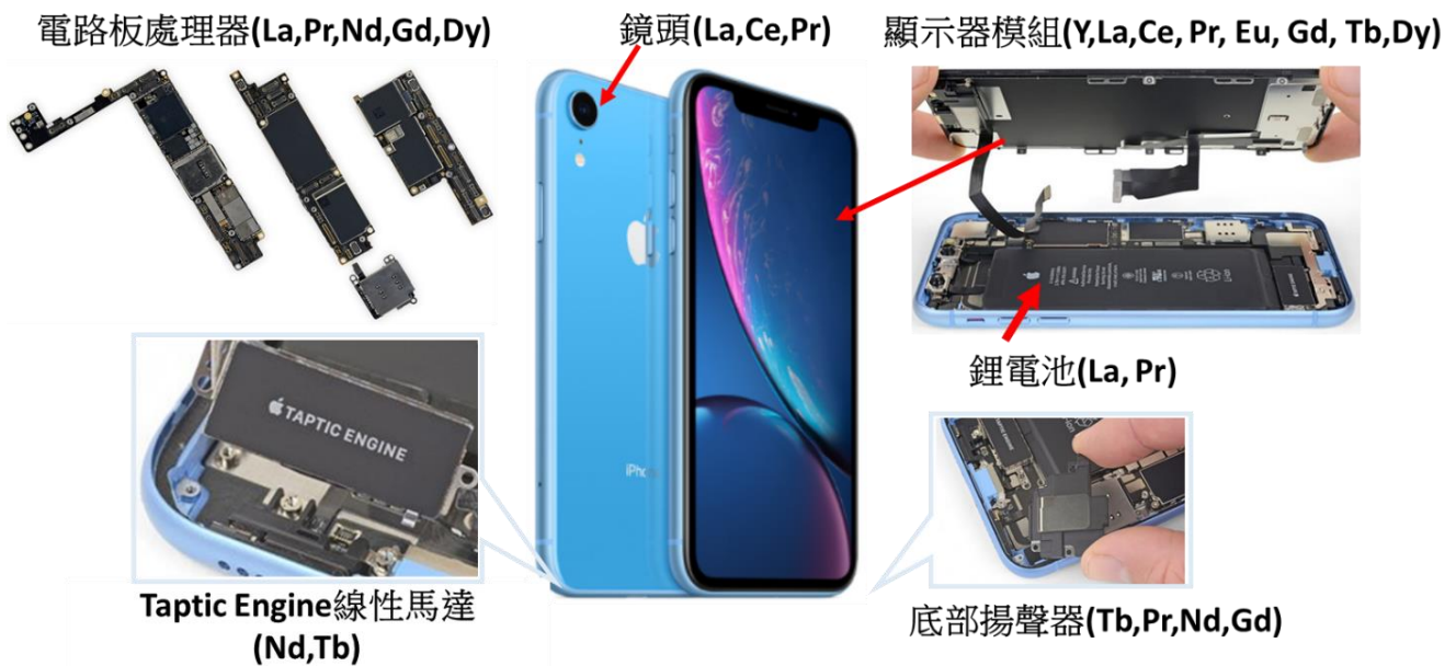
圖一 iPhone X 手機硬體結構中稀土的角色
