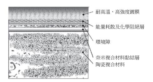
資料來源: Ceramic Transactions /金屬中心 MII-ITIS 研究團隊整理 **圖 1 1,650℃條件下使用的先進 T/EBC 設計原理**
