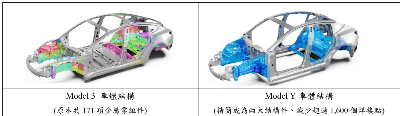
圖 2 Tesla Model Y 的巨型鋁壓鑄結構件示意圖
